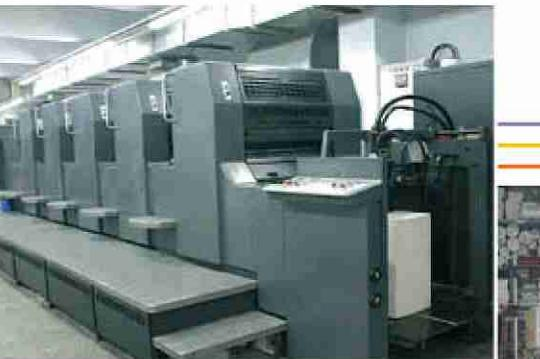
La división gráfica dispone de máquinas de offset plano y rotativo, tipografía y serigrafía equipadas con hasta 7 cuerpos de impresión para la estampación a dos caras de forma simultánea, y con sistemas electrónicos para el registro del color.
